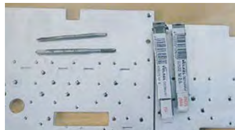
Die Bearbeitung eines Aluminiumbauteils mit VÖLKELE Maschinengewindebohrern mit Übermaß Machining a component with a VÖLKELE Machine Tap with Oversize
