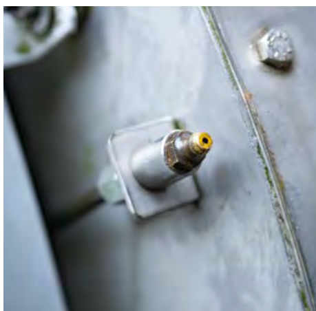
Reinigen und Nachschneiden von Schmiernippel-Gewinden Re-cutting and cleaning of grease nipple threads
